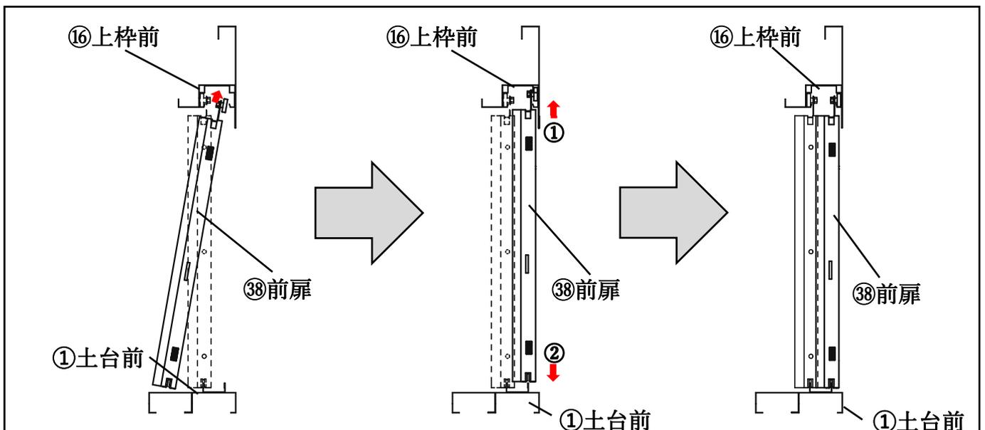
④戸車金具③⑨に高さ調整ボルト、SW 付ナットを取り付ける。
